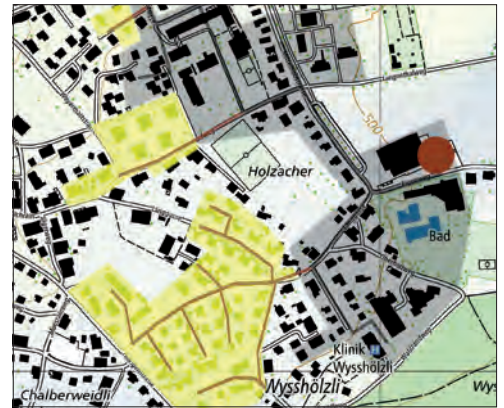
Wärmeverbund Buchsi Ost mit dem Standort der Zentrale (Kreis), dem bereits mit Fernwärme erschlossenen Gebiet (grau schattiert) und den nächsten Erweiterungsetappen (gelb). (Bild: ewk)
